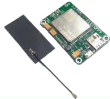
T1122 7Semi EC200U-CN LTE 4G GPS GNSS Mini Industrial Modem
